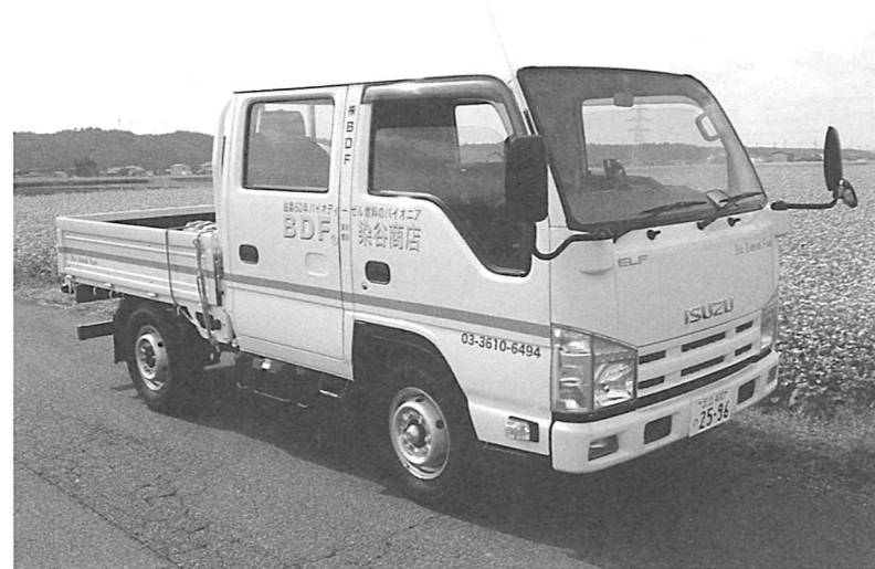
▲実験車両 イスズエルフ 2010年 コモンレール式燃料噴射ポンプ DPF搭載 新長期規制適合車 2010年10月より14000km走行 B100、高度精製燃料を使用 オイル交換 5000km毎 DPF再生が軽油と同等とはいかないが、走行には一切問題なし。 -5℃にて始動確認済み。今後もB100にて継続予定。
